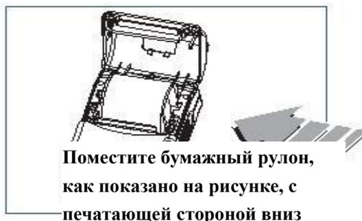
③ Отрегулировав упорный щит бумажного рулона на нужную ширину, закройте верхнюю крышку для печати;
